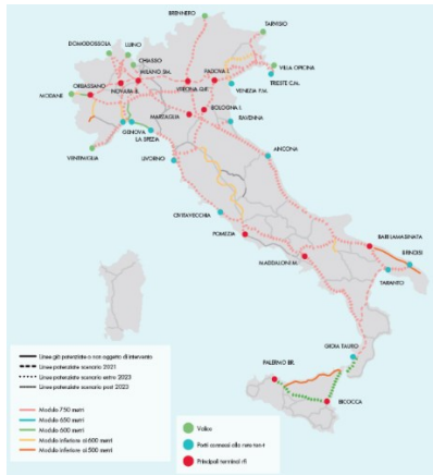
Adeguamento del Modulo (fonte RFI)
