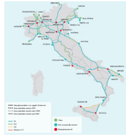
Adeguamento del peso assiale (fonte RFI)
